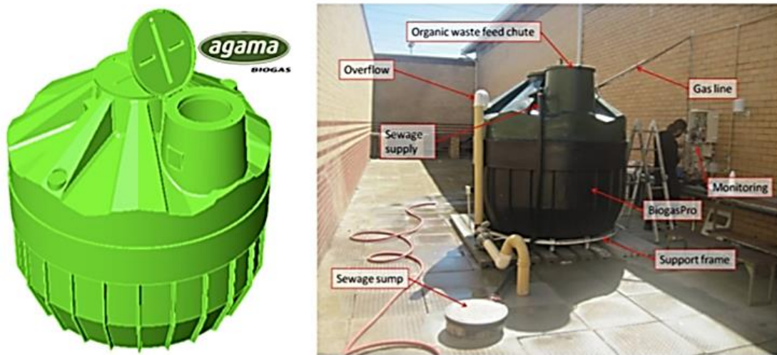
Figure 8: PBDs SA Agama Biogas-Pro design
