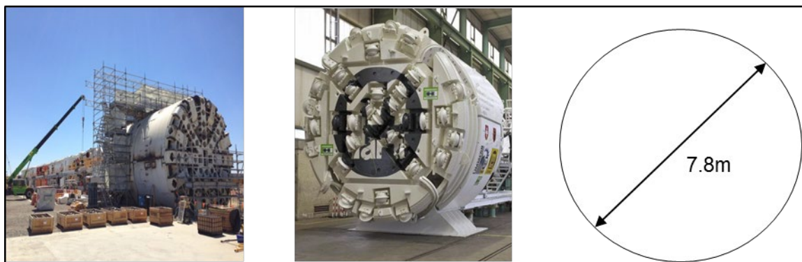
Figure 35- Tunnel Boring Machine (Van Der Berg D, 2014)
