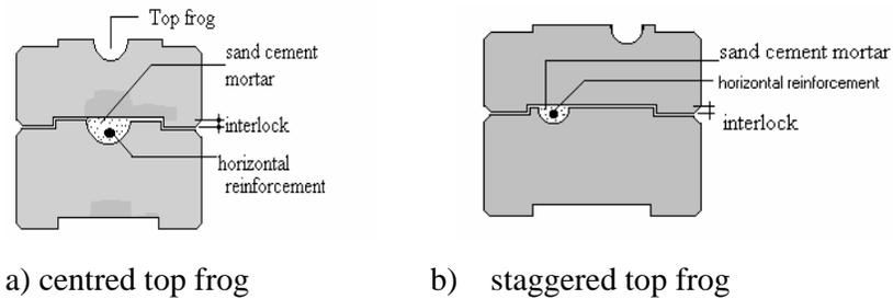
Figure 7.12. Modified conduit blocks
