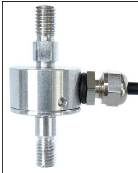
Figure 3-2: Lorenz Messtechnik K-1107 10 Newton tension force sensor photograph. (Lorenz Messtechnik GmbH, 2015)
