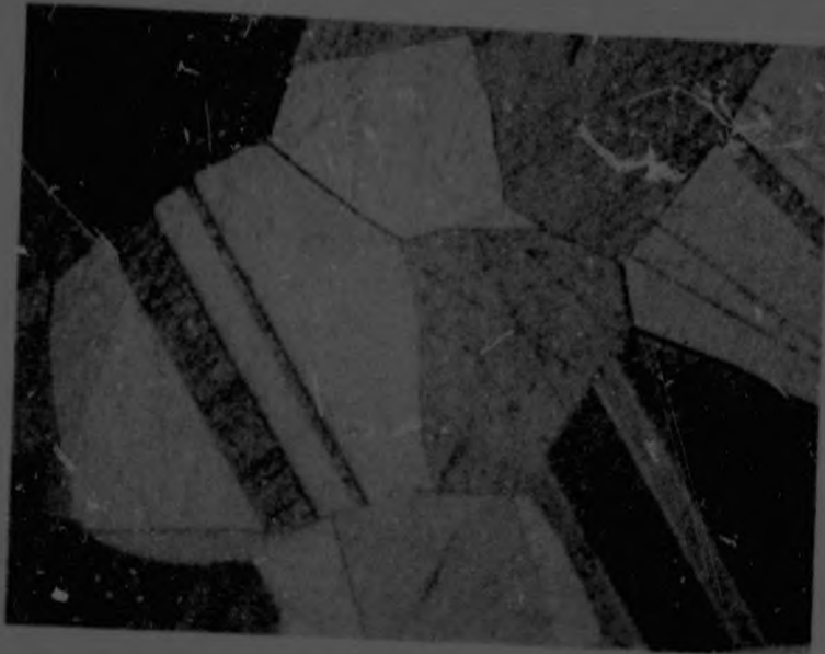
FIGURE 3.10 : Cu 5 Sn (x 200)
