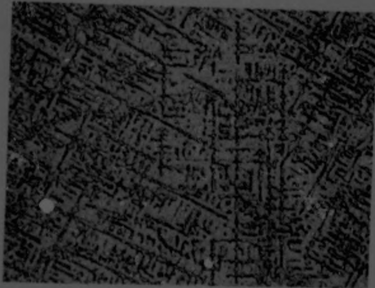
FIGURE 3.11 : Cu 10 Sn (x 200)
